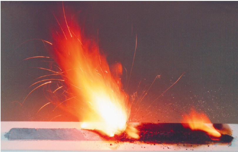
Abbildung 25: Messen der Abbrandzeit in einer Schüttung
