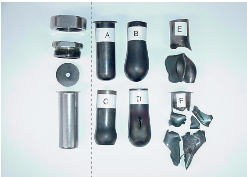
Abbildung 5: Links intakte Stahlhülse vor dem Test, rechts verformte bzw. zerlegte Hülsen nach dem Test
