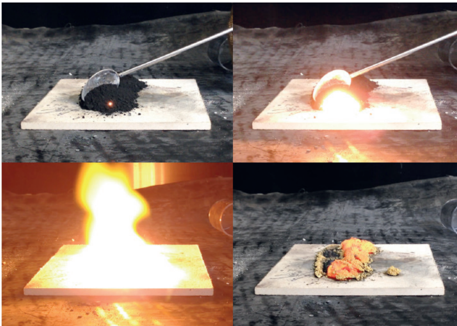
Abbildung 27: Pyrophores Verhalten von nanoskaligem Titan
