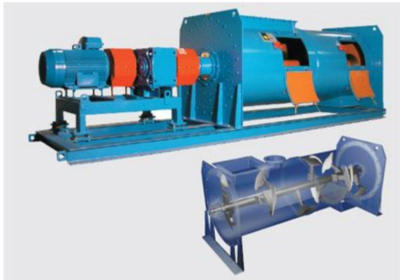
Die Verwendung der unterschiedlichen Typen ist abhängig vom gewünschten Durchsatz, von der Größe und Härte des Mahlgutes und von der gewünschten Qualität des Mahl- bzw. Mischvorgangs. Die Verwendung der verschiedenen Gerätetypen führt zu einer unterschiedlichen Beanspruchung des Materials.
