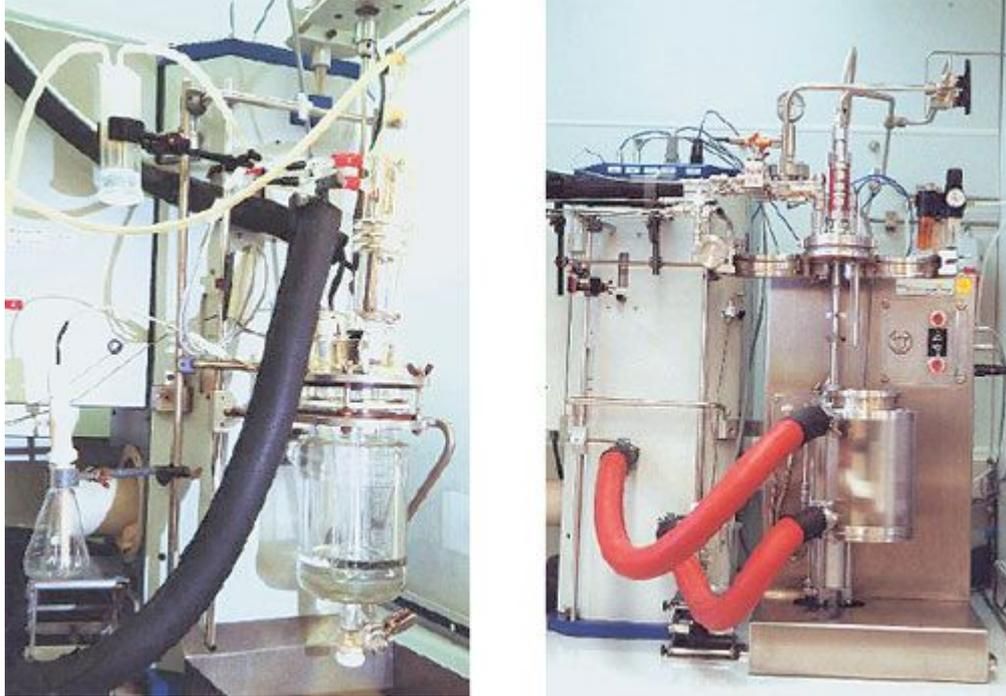
Abbildung 27: Ermittlung der Reaktionswärme einer Polymerisationsmischung (Styrol/Butadien) im Wärmeflusskalorimeter. Während der Messung steigt die Viskosität an und beeinflusst durch die Bildung von Wandbelägen sehr stark die Wärmeabfuhr. Je nach Auswahl der Basislinie können völlig unterschiedliche Reaktionswärmen bestimmt werden.
