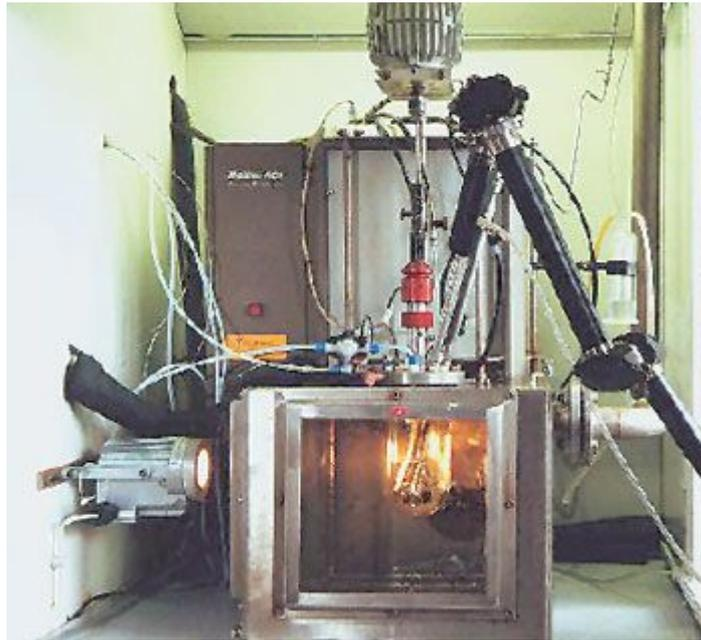
Abbildung 29: Die Kombination Reaktionskalorimeter/Online-Spektroskopie ermöglicht es, die Bildung von End- und Zwischenprodukten zu beobachten
