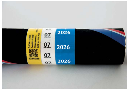
Abbildung 24: Beispiel einer gekennzeichneten Schlauchleitung mit QR-Code
