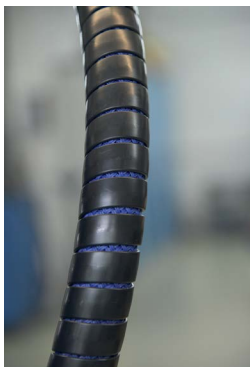
Abbildung 13d: Scheuerschutzspiralen aus Kunststoff und Metall
