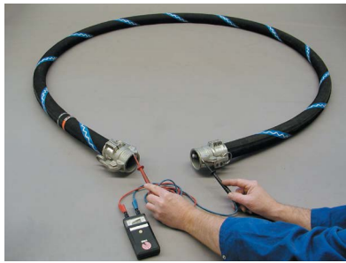
(a) Widerstandsmessung Schlauchleitung
