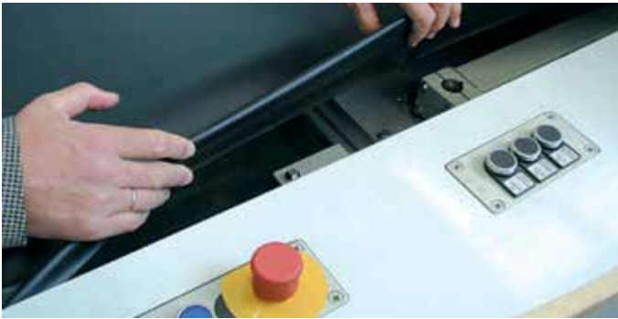
Abbildung 49: Trennende Schutzvorrichtung aus ungeeignetem Material (zu geringe Festigkeit)
