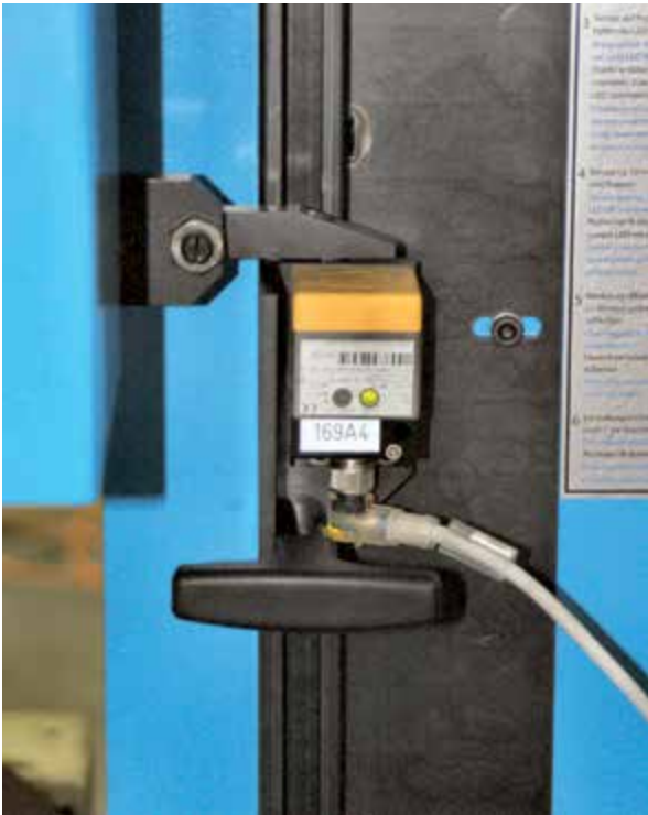
Abbildung 87: Übernahme des Steuerbefehls mit Hilfe eines zweikanalig ausgeführten, berührungslos wirkenden Positionsschalters
