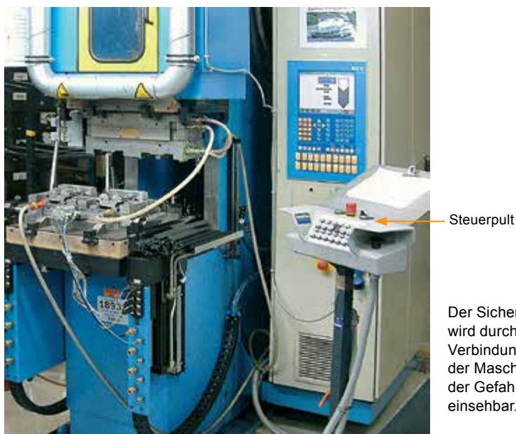
Abbildung 84: Schwenkbares Zweihand-Steuerpult an einer Spritzgießmaschine
