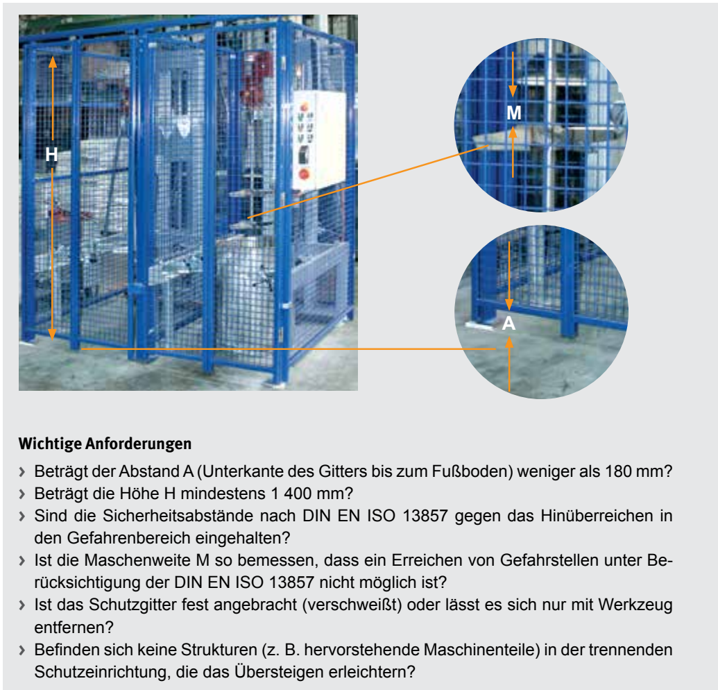
Abbildung 11: Anforderungen an trennende Schutzeinrichtungen im Hinblick auf das Umgehen
