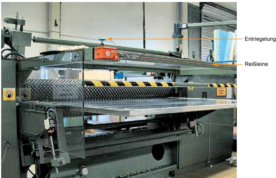
Abbildung 31: Not-Halt-Ausrüstungen (Reißleine) am Einlauf einer Profil-Bandmesserschneidemaschine
