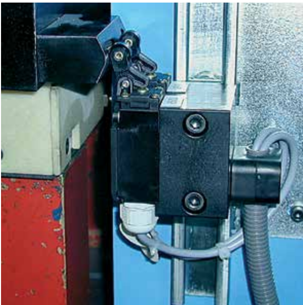
Abbildung 86: Übernahme des Steuerbefehls durch eine Nockenbetätigung
