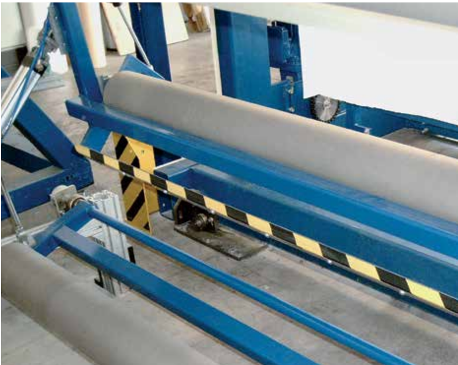
Abbildung 91: Tipptaster sichert Schwenkbewegung an pneumatisch schwenkbarer Umlenkwalze
