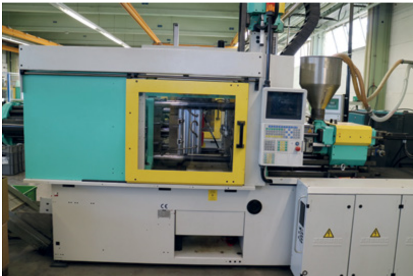
Abbildung 1: Horizontal schließende Spritzgießmaschine (ohne Werkzeug, alle Schutzeinrichtungen sind geschlossen)
