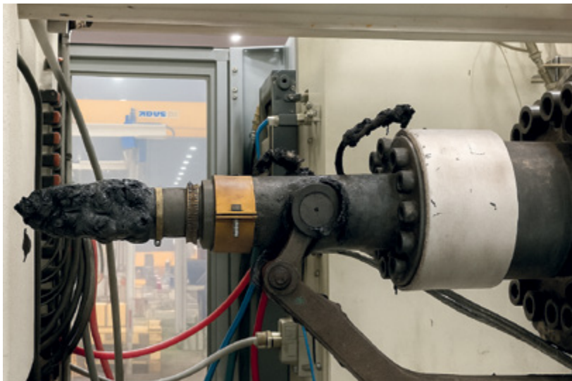
Abbildung 49: Mit Kunststoffablagerungen verstopfte Spritzdüse
