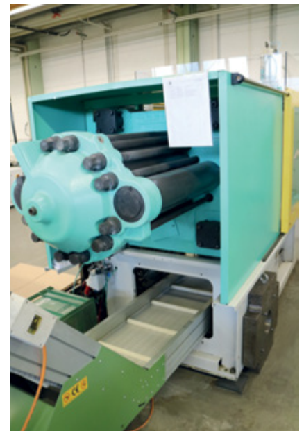
Abbildung 46: Spritzgießmaschine mit Förderband
