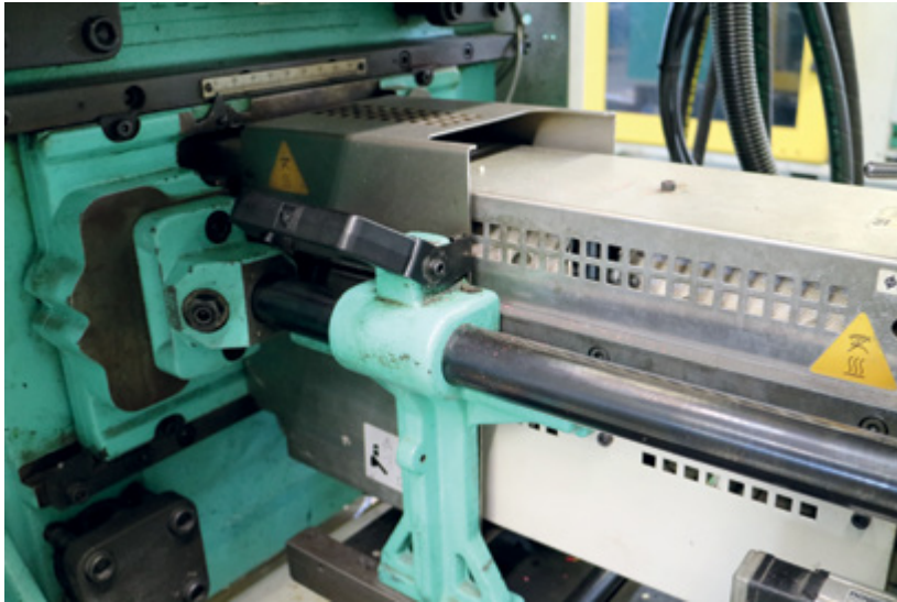
Abbildung 48: Verriegelte, trennende Schutzeinrichtung für den Düsenbereich (Düsenabdeckung)
