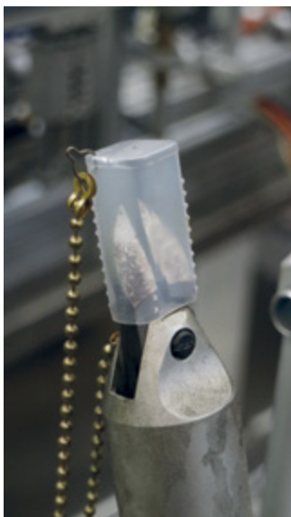
Abbildung 33: Automatische Angusschere mit Schutzhülle zur Vermeidung von Schnittverletzungen
