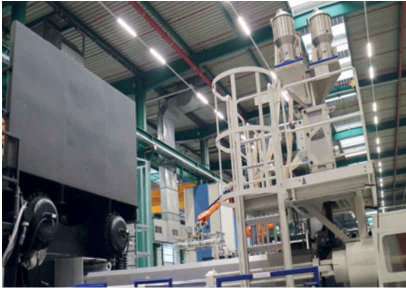
Abbildung 30: Fest montierte Aufstiegshilfe
