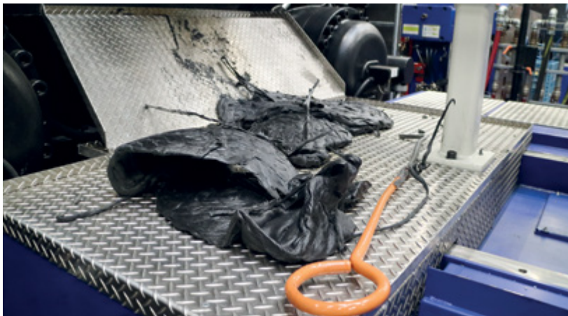
Abbildung 59: „Fladenhaken“ zum Entfernen von austretender flüssiger Formmasse
