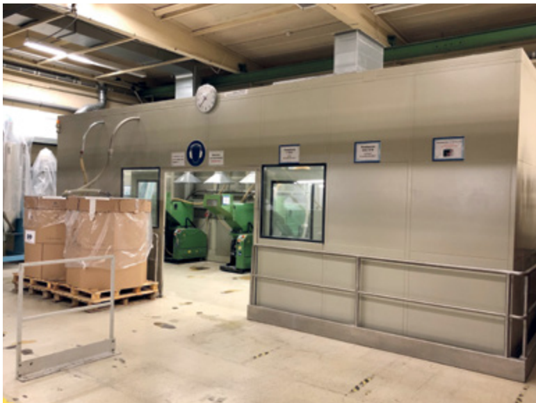
Abbildung 43: Aufstellung von Mühlen in einem lärmtechnisch abgegrenzten Raum
