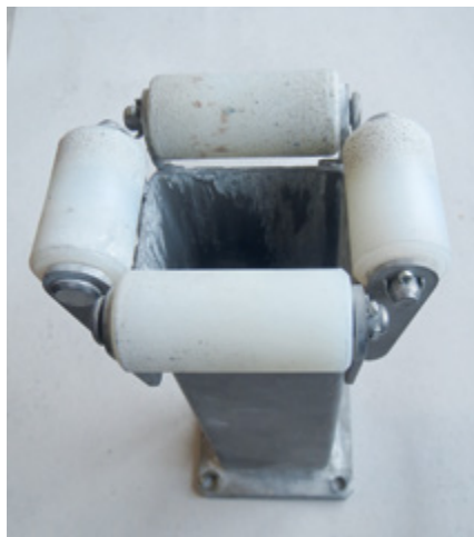
Abbildung 56: Rollenzuführung mit Stützen für Gummistreifen
