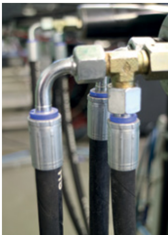
Abbildung 3: Normgerecht eingebundener Schlauch
