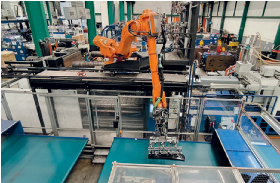
Abbildung 60: Gesicherter Wirkbereich eines Roboters an einer Spritzgießmaschine
