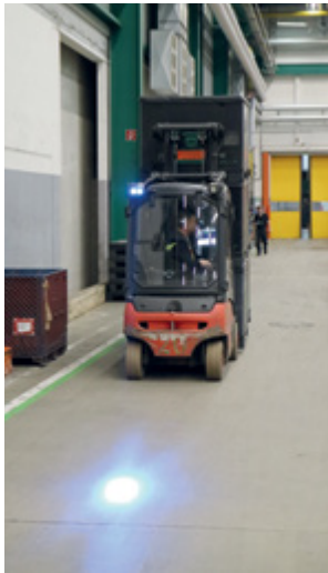
Abbildung 36: Erhöhung der Sicherheit von Fußgängerinnen und Fußgängern durch die Verwendung von BlueSpots an Gabelstaplern
