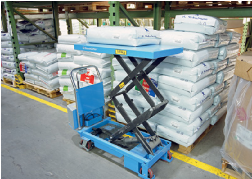
Abbildung 31: Ergonomischer Transport und ergonomisches Anheben von Kunststoffsäcken
