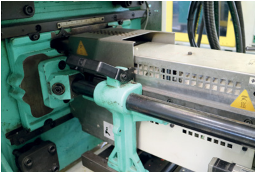
Abbildung 11: Typische Ausführung einer beweglichen verriegelten trennenden Schutzeinrichtung im Düsenbereich
