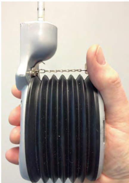
Abbildung 34: Messung mittels Prüfröhrchen und Handpumpe
