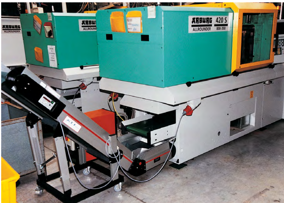
Abbildung 42: Spritzgießmaschine mit Formteilmförderung aus der Stirnseite
