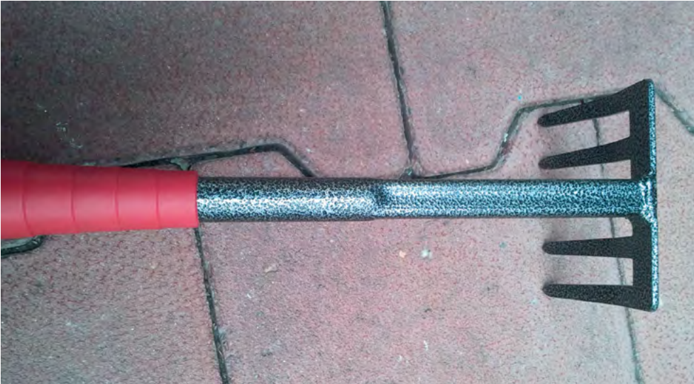
Abbildung 51: „Kralle“ zum Entfernen von ausgetretener flüssiger Formmasse
