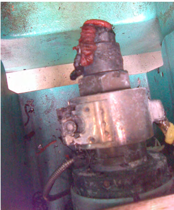
Abbildung 45: Mit Kunststoffablagern verstopfte Spritzdüse
