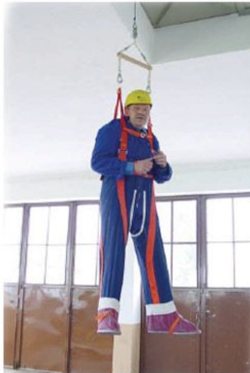
Abbildung 18: Silohose als Teil einer Siloeinfahreinrichtung
