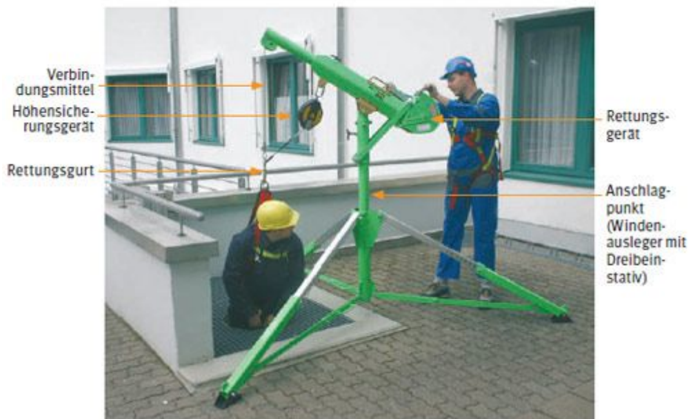
Abbildung 5: Beispiel für ein Rettungssystem mit Höhensicherungsgerät als Zweitsicherung
