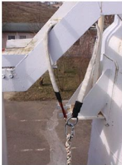
Abbildung 42: Schlinge mit Kantenschutz-Überzug (sogenannte Scharfkantenschlinge)
