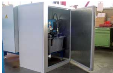
Abbildung 20: (Geöffnete) Kapselung eines Hydraulikaggregats
