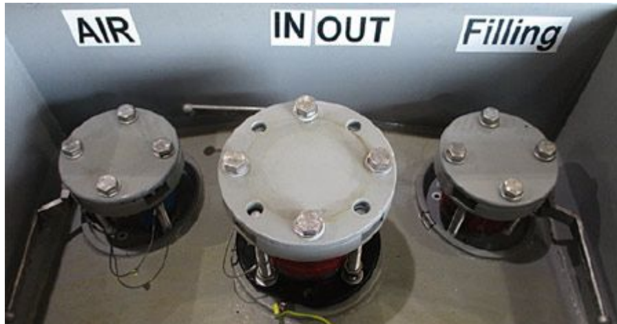
Abbildung 17: Kennzeichnung der Anschlüsse mit Klartext (AIR – Druckstutzen, IN/OUT – Steigrohr, FILLING – Füllstutzen)
