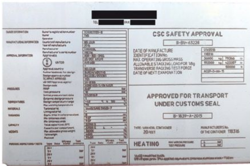
Abbildung 20: Tankschild an Tankcontainern – Angaben zu Kessel und Prüfungen (2,5-jährige und 5-jährige sowie CSC-Prüfung)
