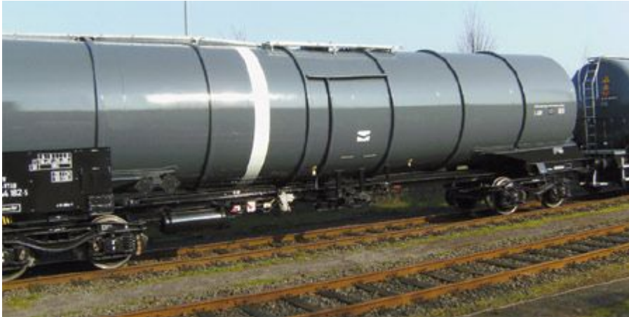
Abbildung 11: Kennzeichnung für Kesselwagen mit Zwangsbelüftungsventil
