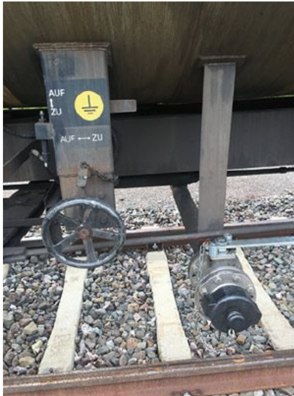
Abbildung 46: Erdunglaschen an einem Kesselwagen
