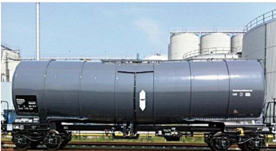
Abbildung 12: Kennzeichnung für Kesselwagen mit Zwangsbelüftungsventil (nach UIP)
