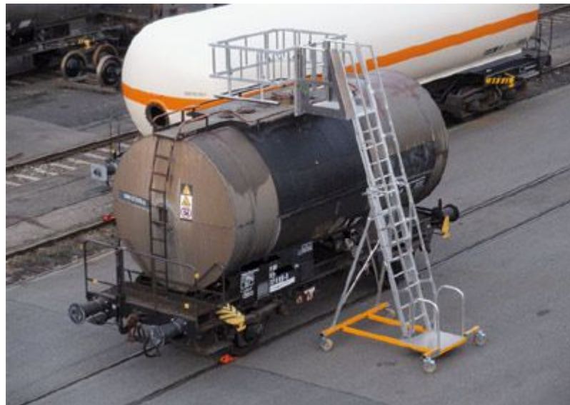
Abbildung 29: Spezialeiter mit absenkbarer Fußleiste
