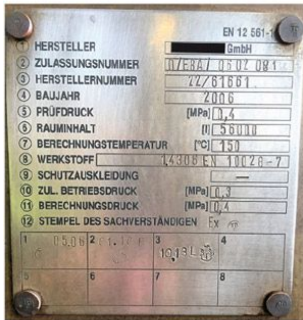
Abbildung 19: Tankschild an Kesselwagen für flüssige Produkte
