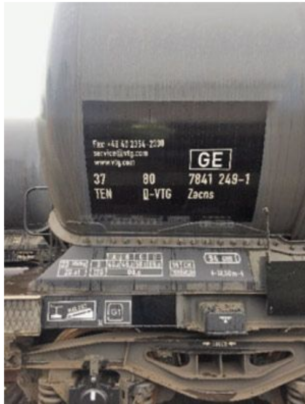
Abbildung 22: Anschriftentafel an Kesselwagen für flüssige Produkte
