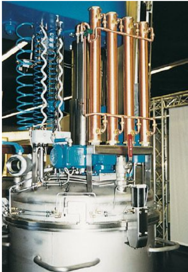
Abbildung 11: Kühl- und Kondensationseinrichtung auf Rührbehälter beim Firnisansatz
