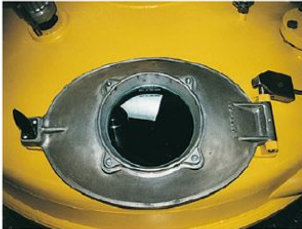
Abbildung 4: Abdeckung einer Beschickungsöffnung im Rührbehälterdeckel mit Abschaltung des Rührwerksantriebs über einen Positionsschalter beim Öffnen der Abdeckung
