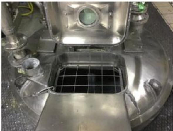
Abbildung 5: Schutz gegen Zugriff zur Rührwelle über Stäbe in der Behälteröffnung, deren Abstand untereinander so bemessen sein muss, dass ein Durchgreifen zur Rührwelle nicht möglich ist (DIN EN ISO 13857 60) )
