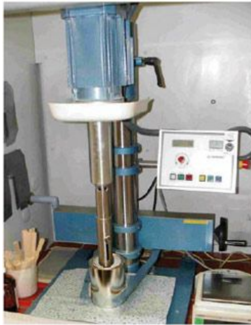
Abbildung 2: Laborrührwerke mit Rührwellenschutzrohr
