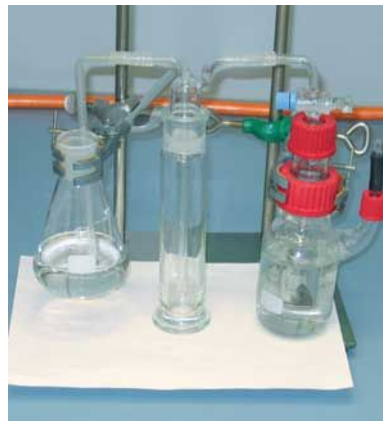
Abbildung 20: Gaseinleitung über Sicherheitswaschflasche (kann nur bei ausreichender Standsicherheit frei stehen)
