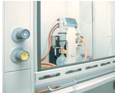
Abbildung 19: Membranpumpenstand mit Kondensator und Lösemittelauffangvorrichtung
