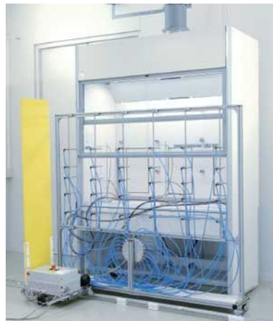
Abbildung 10: Prüfaufbau mit dem Messgitter der Prüfgasaufnahmeköpfe, davor die auf einem Wagen bewegliche Platte, die die Beeinflussung des Abzugs durch Strömungen im Raum simuliert
