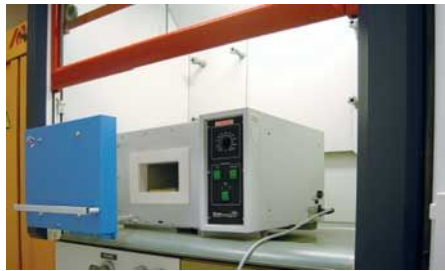
Abbildung 14: Ofen im Abzug, so aufgestellt, dass der Abzug keine Wirkung hat
