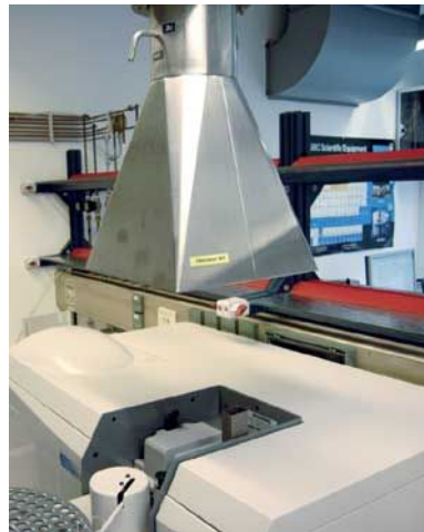
Abbildung 24: Absaugung an einem AAS-Gerät
