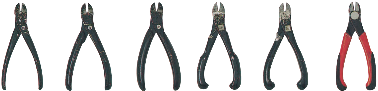
Abbildung 42: Entwicklungsreihe einer ergonomischen Zange
