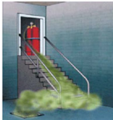
Abbildung 5: Ausbreitungsverhalten am Beispiel von Flüssiggas
