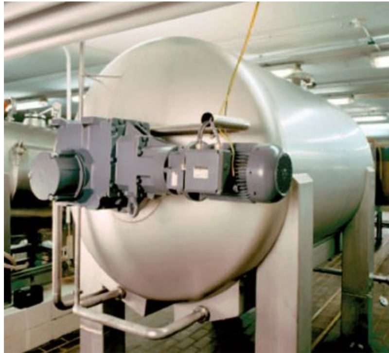
Abbildung 5: Elektromotor für 380 V an einem Rührbehälter
