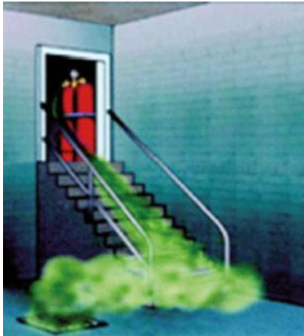
Abbildung 13: Ausbreitungsverhalten am Beispiel von Flüssiggas
