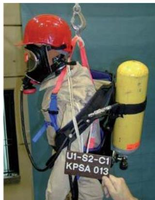
Abbildung 4: Sicherungssystem beim Einsteigen in einen Kanal mit Sicherungsposten
