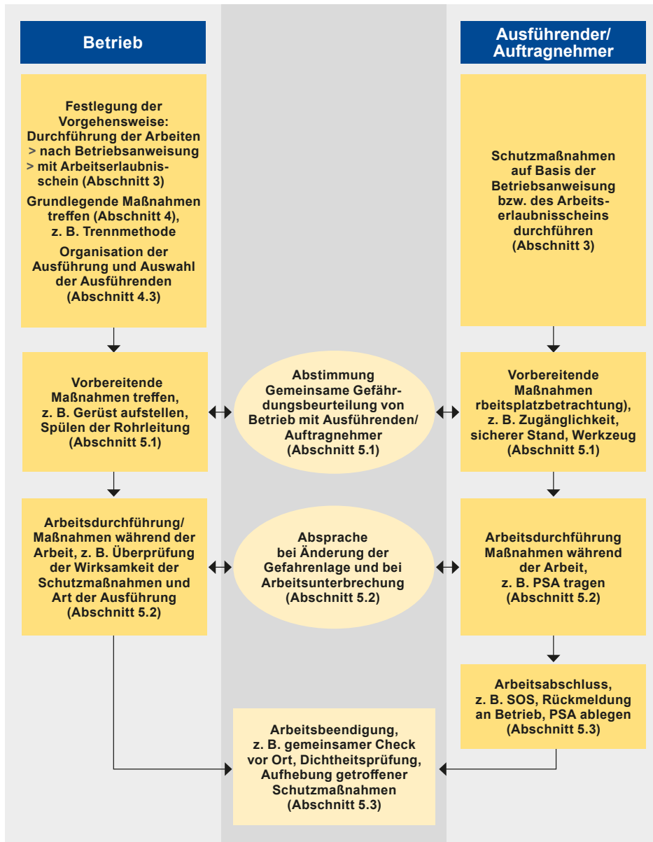
Abbildung 15: Arbeitsablauf beim Öffnen von Rohrleitungen
