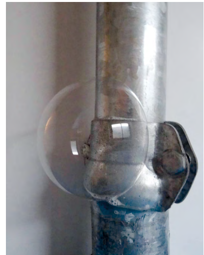
Abbildung 30: Blasenprüfung mit schaumbildender Flüssigkeit
