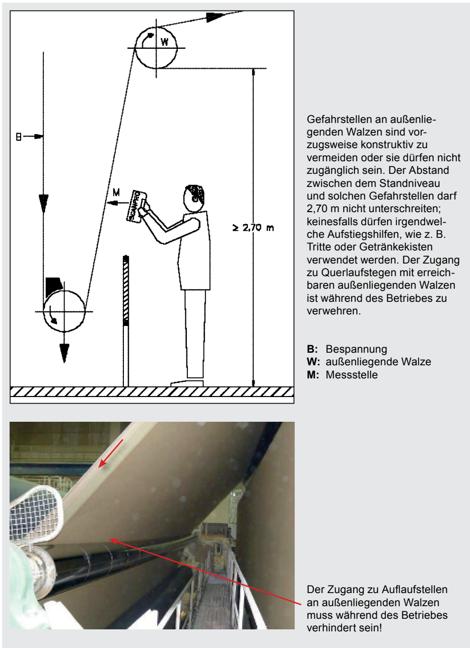
Abbildung 6: Bereiche mit außenliegenden Walzen (Lebensgefahr!)
