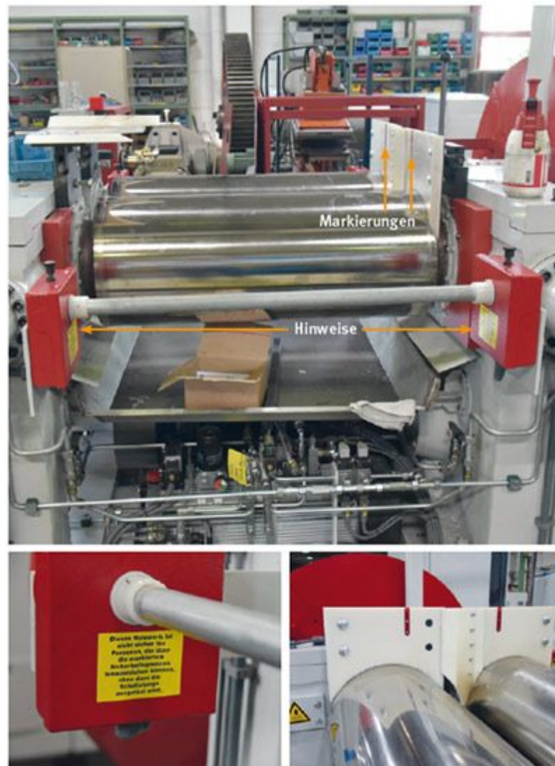
Abbildung 11: Sicherheitsgrenzen gemäß DIN EN 1417
