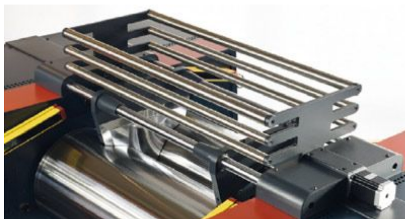
Abbildung 18: Absicherung eines Walzwerkes mit BWS
