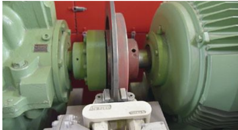
Abbildung 17: Nachrüstung einer Walzwerksbremse an der Motorkupplung
