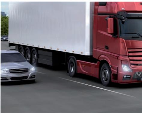
Eine vorausschauende Kamera zur Fahrspur-erkennung in Kombination mit einem in die Lenkung integrierten Sensor schützt den Fahrer vor unbeabsichtigtem Verlassen der Fahrspur: Sobald er sich der Fahrbahnmarkierung nähert, sodass die Gefahr besteht, sie unbeabsichtigt zu überfahren, erhält die Lenkung ein Signal von der Kamera, damit das Fahrzeug automatisch wieder in die Fahrbahnmitte zurücklenkt. Der Spurhalteassistent (Lane Keeping Assist System – LKAS) ist eine Weiterentwicklung des
