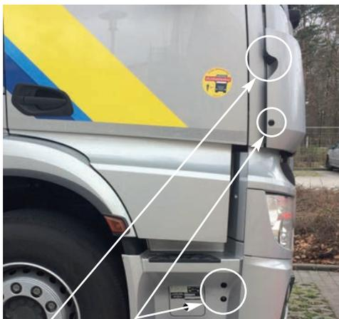
Kamera und Ultraschallsensoren am vorderen Seitenbereich
