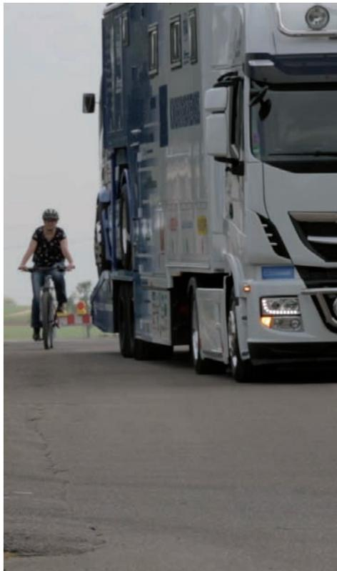
Radfahrer, die sich neben oder nahe vor einem Fahrzeug befinden, geraten aufgrund von Toten Winkeln im rechten Front- und Seitenbereich des Fahrzeugs schnell in Gefahr.
