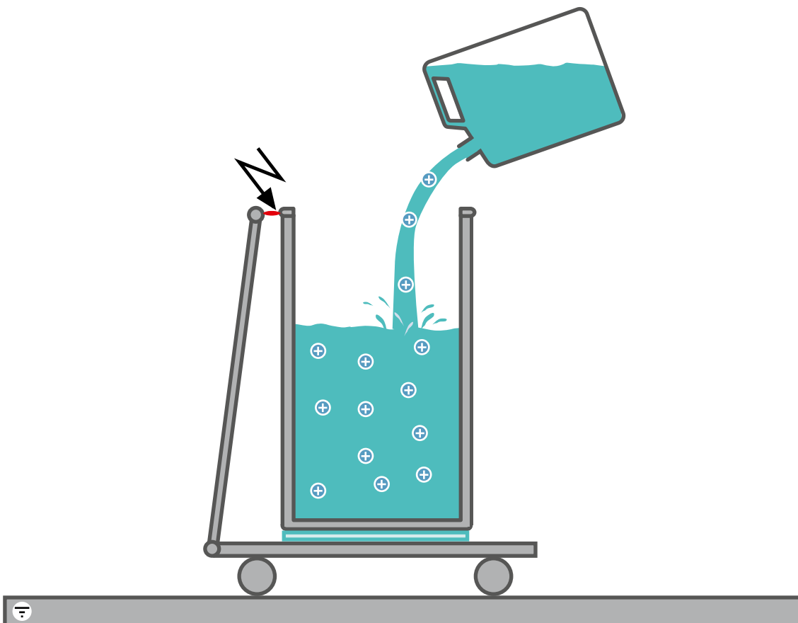
Abb. 21.3: Funkenentladung durch aufgeladenes Metallfass
