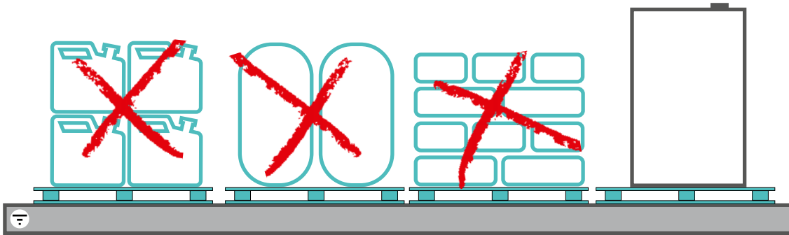
Abb. 25: Vermeiden von Büschelentladungen durch Verwenden von leitfähigen, geerdeten Packmitteln (keine Kunststoffsäcke, keine Kunststoffbehälter)
