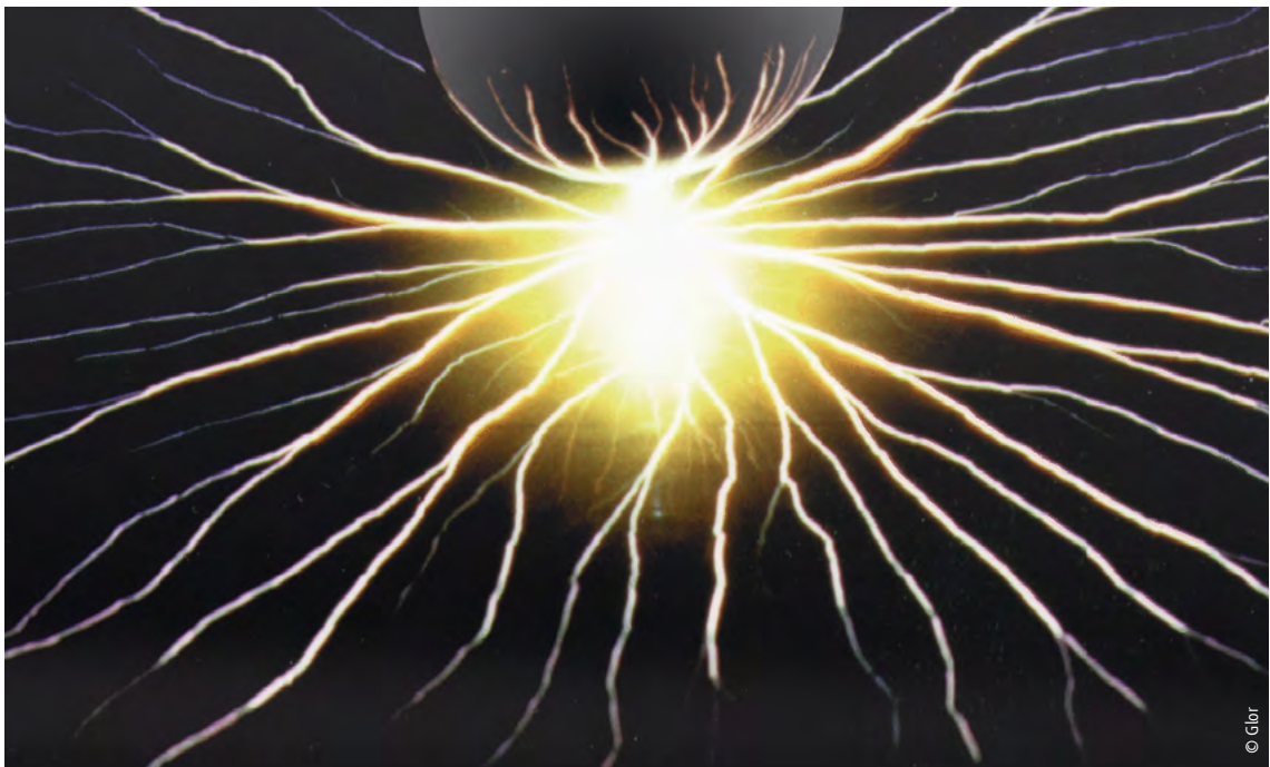
Abb. 27: Foto einer Gleitstielbüschelentladung
