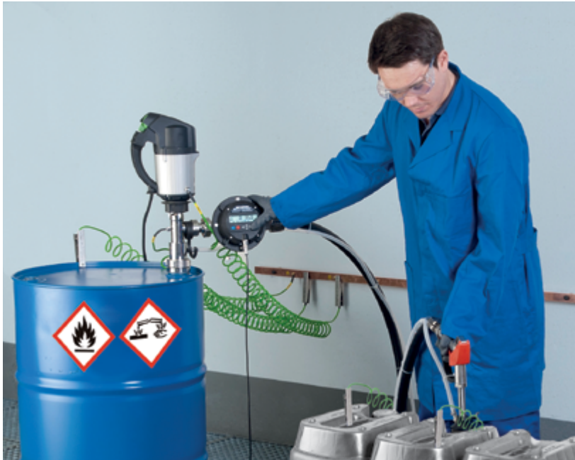
Abbildung 14: Umfüllen einer Säure aus einem 200 Liter Fass
