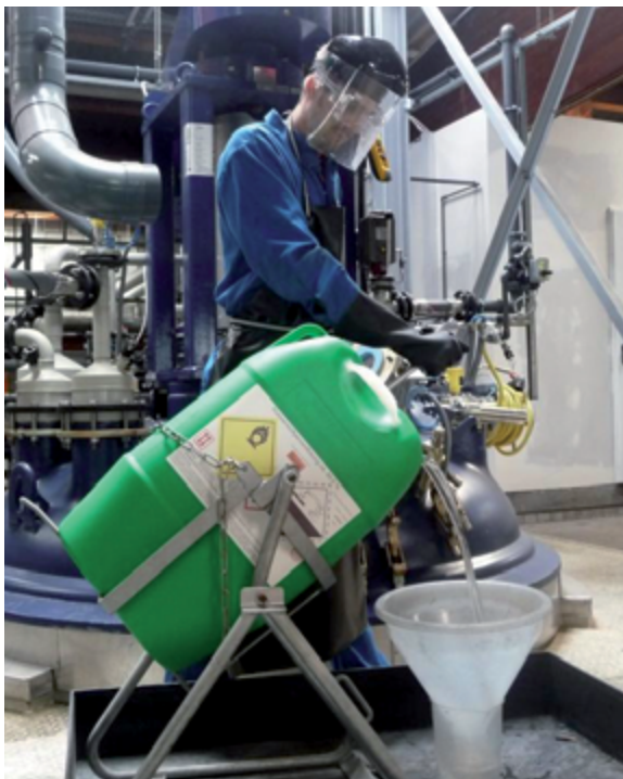
Abbildung 15: Abfüllen von 30%igem Wasserstoffperoxid mit einem Kippgerät
