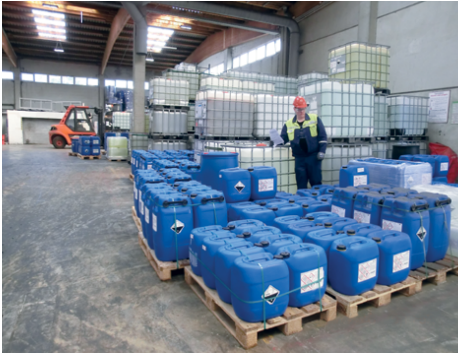
Abbildung 11: Lagerung von Säuren in Kanistern und IBC
