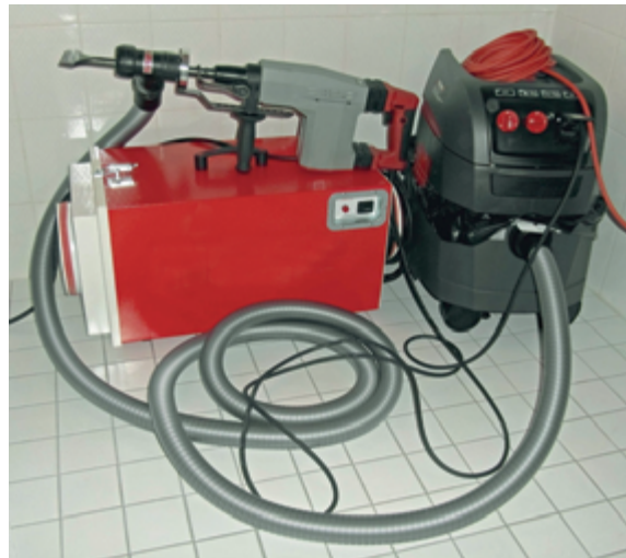
Abbildung 8: Abgesaugte Maschine (hier Abbruchhammer), Bau-Entstauber und Luftreiniger; zusammen mit einer Abschlottung sind die Basisausrüstung staubarmer Techniken für jeden Betrieb
