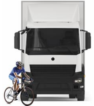
Detektion von gefährdeten Radfahrern / Verkehrsteilnehmern im vorderen toten Winkel des Fahrzeugs
