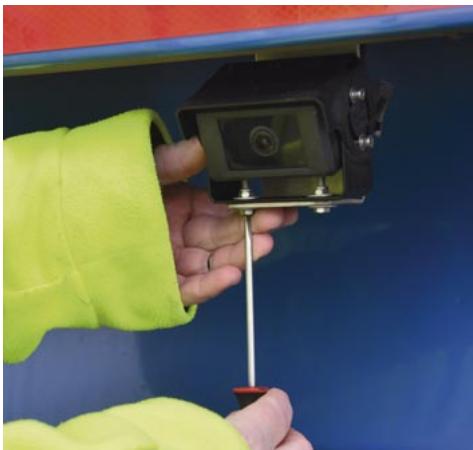
Nachträglicher Einbau einer RAS-Kamera an einem Spezialfahrzeug
