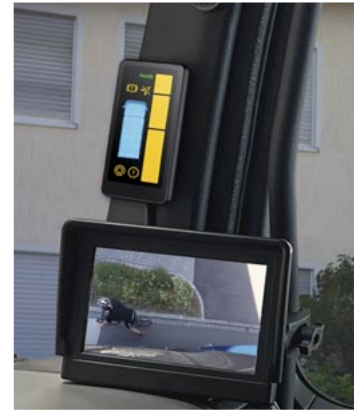
Montagebeispiel: Display des Abbiegeassistenten und Monitor des KMS in der Fahrerkabine.
