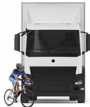
Detektion von gefährdeten Radfahrern / Verkehrsteilnehmern im vorderen toten Winkel des Fahrzeugs
