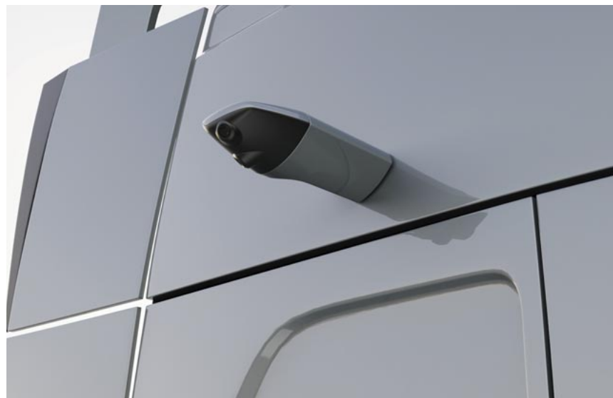
Beispiel einer Systemkomponente: KI-Kamera eingefasst in kompaktem „Kamerawing“ (verlängerbar)
