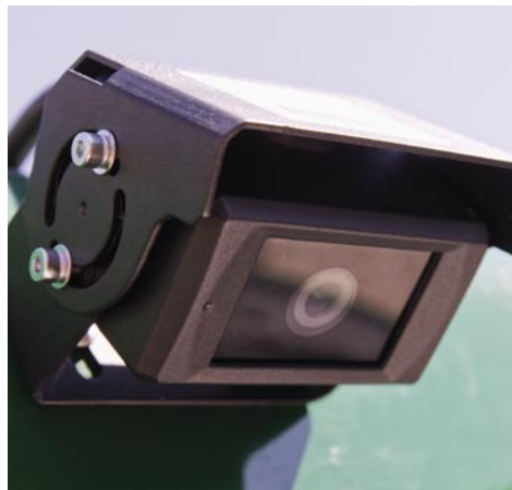
Detailaufnahme einer am Heck des Fahrzeugs montierten Rückfahrkamera
