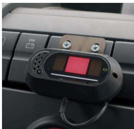
Montagebeispiel: Display des MOIS im Fahrerhaus
