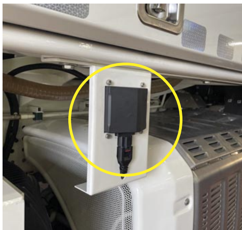
Montagebeispiel: Radarsensor an unterer, rechter Seite des Lkw
