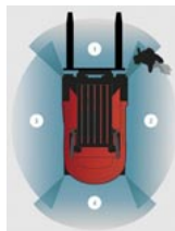
Die Aufnahmen der einzelnen Kameras zeigen zusammen auf dem Monitor angeordnet die Rundumsicht.
