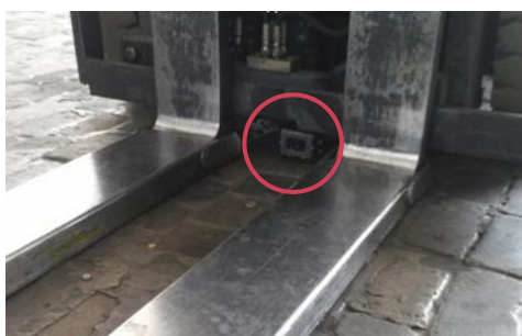
Gabelträgerkamera für die indirekte Sicht nach vorn.
