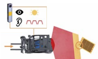
Objektdetektion innerhalb des Warnfeldes: Die Signalleuchte leuchtet gelb, zudem wird ein Warnton aktiviert.
