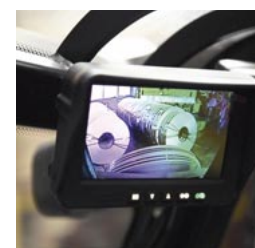
Der Monitor zeigt dem Fahrer/Bediener die Aufnahme der Gabelträgerkamera.
