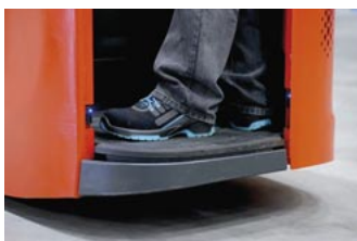
Die Lichtschränke überwacht den Rand der Fahrzeugplattform und verhindert das An- und Weiterfahren, falls ein Teil des Fußes über die Fahrzeugkante hinausragt.
