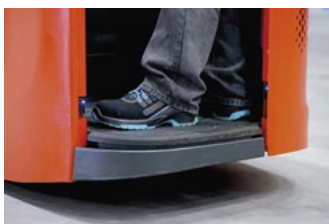
Die Lichtschranke überwacht den Rand der Fahrzeugplattform und verhindert das An- und Weiterfahren, falls ein Teil des Fußes über die Fahrzeugkante hinausragt.
