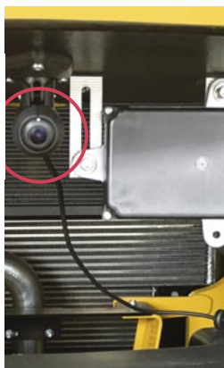
Radarsensor in Verbindung mit einer Rückfahrkamera
