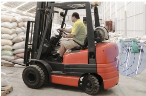
Zwei am Heck montierte Ultraschallsensoren (Foto oben) detektieren den rückwärtigen Nahbereich des Gabelstaplers. In der Detektionszone befindliche Objekte werden von den Sensoren erkannt (Grafik Draufsicht Gabelstapler von oben).
