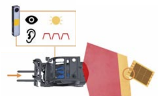
Objektdetektion innerhalb des Warnfeldes: Die Signalleuchte leuchtet gelb, zudem wird ein Warnnton aktiviert.
