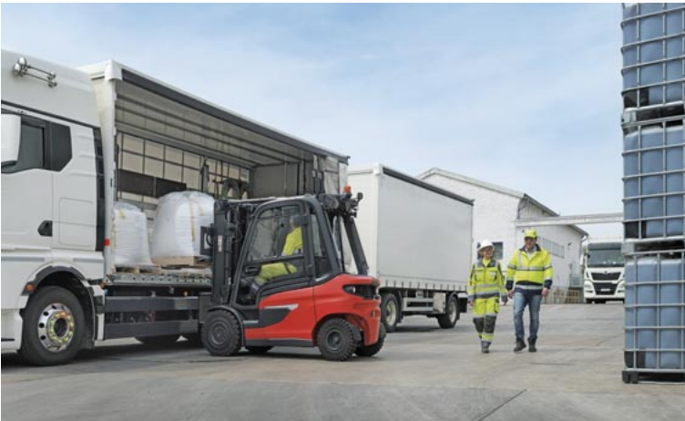
Die KI-Kamera erkennt die Personen hinter dem Stapler. Das System gibt sofort eine Warnung aus und reduziert die Fahrgeschwindigkeit.
