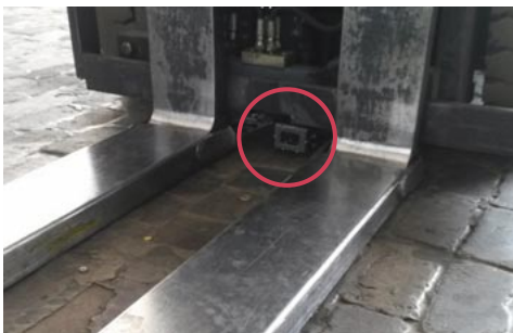
Gabelträgerkamera für die indirekte Sicht nach vorn.
