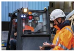
Das am Gabelstapler montierte System erkennt Personen, warnt den Fahrer und vermeidet Fehlalarme.
