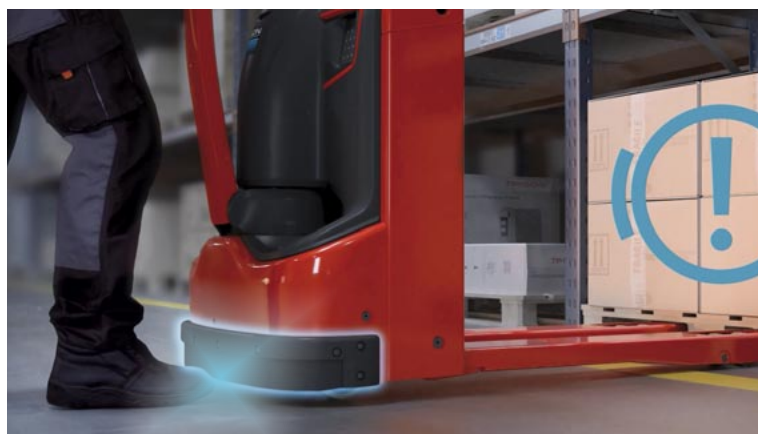
Bei Berührung der aktiven Fußschutzleiste stoppt das MFFZ umgehend und verhindert Fuß- oder Knöchelverletzungen. Mit der STOP&GO-Funktion springt der Mitgänger zusätzlich ein Stück zurück, um sich von dem Fuß des Bedieners zu entfernen.
