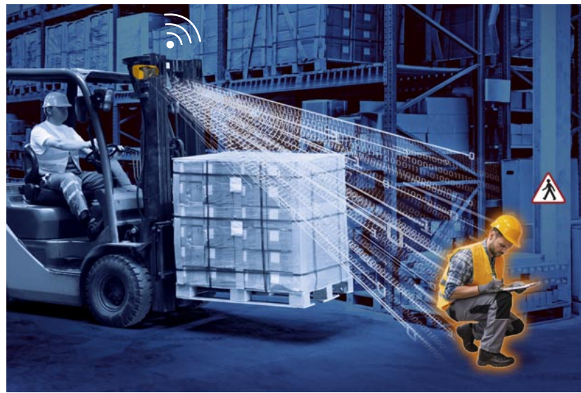
Abbildung oben: Der Sensor überwacht den Bereich in seinem Sichtfeld – auch im toten Winkel des Gabelstaplers – und erkennt jede Körperhaltung.
