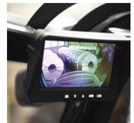
Der Monitor zeigt dem Fahrer/Bediener die Aufnahme der Gabelträgerkamera.
