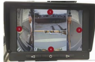
Die Aufnahmen der einzelnen Kameras zeigen zusammen auf dem Monitor angeordnet die Rundumsicht.
