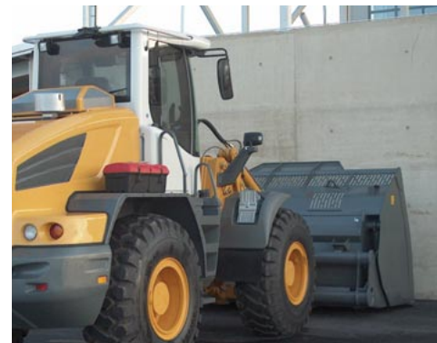
Kamera mit Funkanbindung an einem Radlader mit großer Spezialschaufel, die die direkte Sicht nach vorn stark einschränkt.
