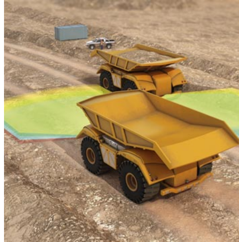
Das Beispiel zeigt ein fahrerloses Bergbaufahrzeug, das sein Umfeld mit Hilfe eines 3D-LIDAR-Sensors analysiert.
