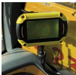
Touchscreen-Display in der Fahrerkabine mit Konfiguration aller Parameter
