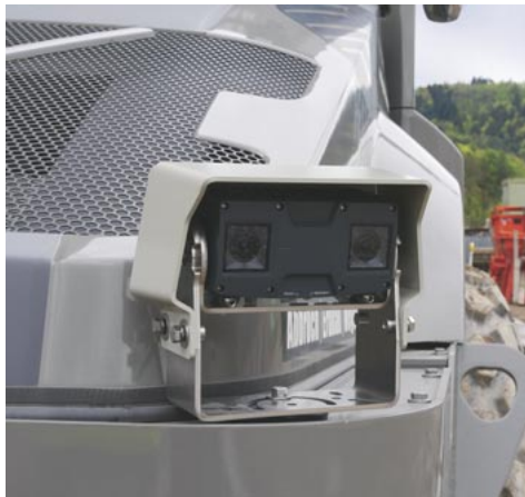
Abbildung rechts: Anwendungsbeispiel 3D-Stereokamera am Heck einer Baumaschine
