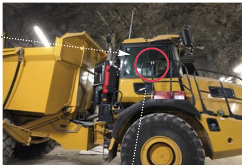
Positionierung der rechten Seitenkamera eines 360°-Systems bei einem Dumper
