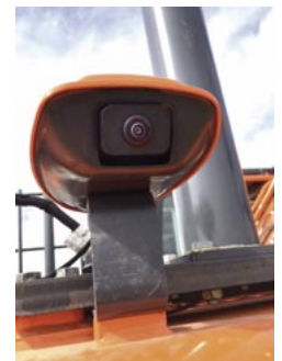
Bild oben: An der Arbeitsmaschine montierte Kamera in robustem Gehäuse
