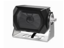
Bild oben: Intelligente Kamera – Beispiel einer Ethernetkamera mit Personen-/Objekterkennung direkt auf der Kamera ohne zusätzliche Hardware.
