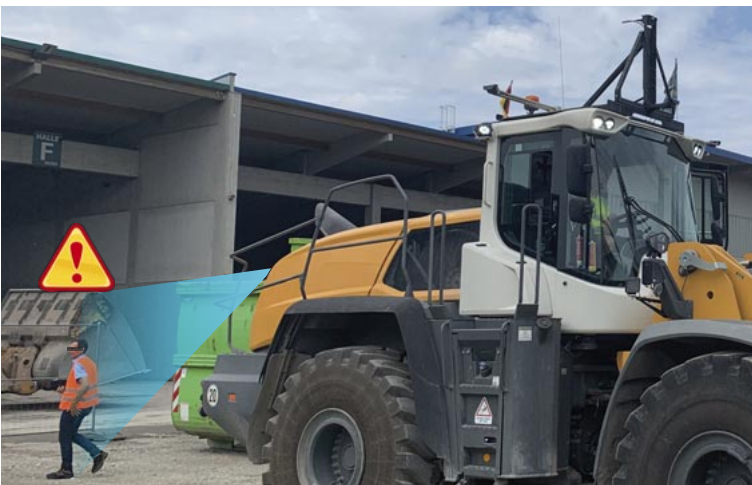
Bild oben: Darstellung der Personenerkennung im hinteren Bereich des Radladers, die sowohl die Warnung an den Fahrer als auch den automatischen Bremsvorgang der Maschine auslöst.
