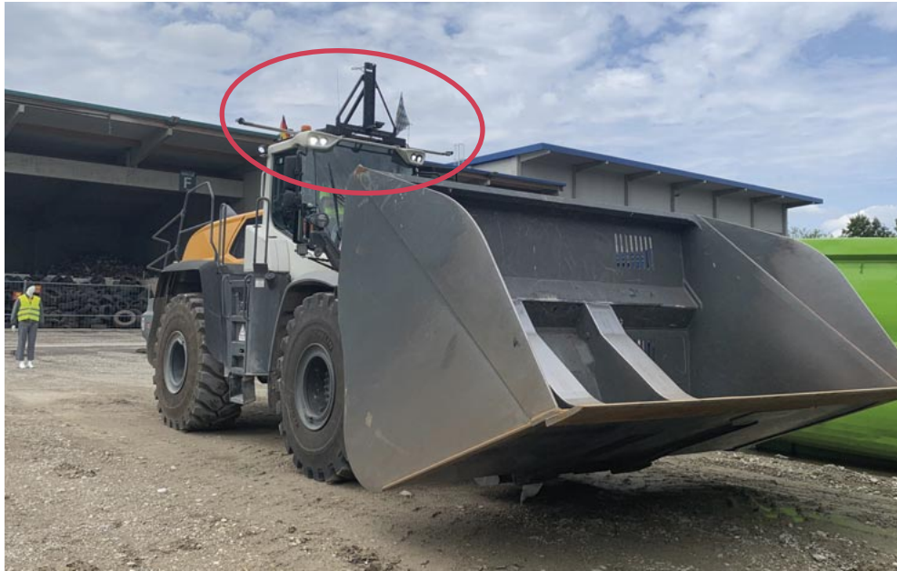
Bild oben: Rundumsicht-KMS bieten dem Bediener Übersicht für die nähere Umgebung. Ein rundum kontrollierbares Sichtfeld ermöglicht schnelles, präzises und stressfreies Arbeiten, auch z. B. bei Spezialanwendungen mit Volumenschaukel (siehe dazu auch DGUV-Publikation „FBHM-109: Radlader mit Leichtgutschaukel“).
