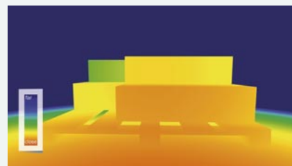
3D-Snapshotaufnahme einer Palette: Die Entfernung der Objekte zum Sensor wird erkannt und durch unterschiedliche Farbgebung dargestellt.
