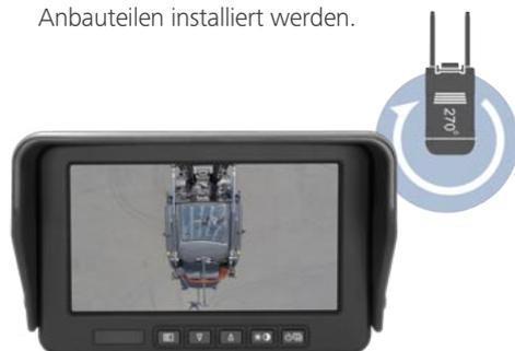
**Weitere Möglichkeiten:** Spezifische Anforderungen, die sich aus dem Arbeitseinsatz bzw. der Art der mobilen Maschine und ihrer Anbauteile ergeben, können besondere Maßnahmen erfordern. So kann beispielsweise durch eine besondere Positionierung der Frontkamera auch über eine Volumenschaukel hinweg gesehen werden (dabei mit Aufbau eine Gesamthöhe von 4m nicht überschreiten).
