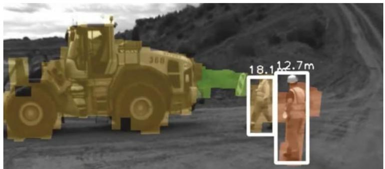
Je nach Applikation können die gelieferten Bilddaten mit vorhandenen oder neu zu integrierenden Systemen kombiniert/konfiguriert und passgenaue „Aktionen“ definiert werden. Bei drohender Kollisionsgefahr wird beispielsweise:
