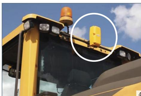
Für abgeschlossene Betriebsgelände/Baustellen mit Eingangs-/Personenkontrolle können sich funkbasierte Transponder-/TAG-Systeme, die den Bediener des Fahrzeugs und die sich der Gefahrenzone nähernden Personen und Fahrzeuge warnen (Bild 4).
