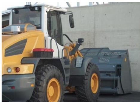
Foto links: Radlader mit Großvolumenschaukel, die die direkte Sicht nach vorn stark einschränkt – hier kann als technische Maßnahme ein KMS mit Funkanbindung eingesetzt werden.
