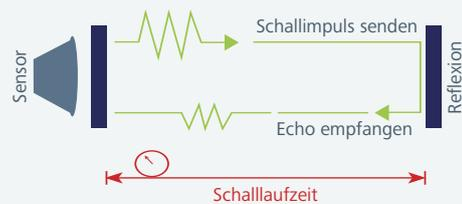
Die Entfernung zum Objekt errechnet sich aus der Differenzzeit zwischen Senden und Empfangen eines Schallimpulses mit einer Frequenz von >20 kHz (optimal 40 bis 60 kHz).
