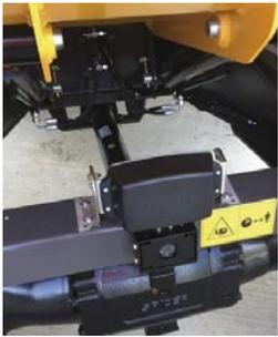
Oberes Bild: Radarsensor an einer Baumaschine
