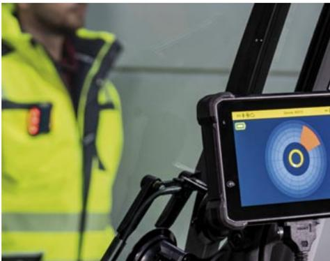
Foto oben: Die TAG-tragende Person wird vom Sensor erkannt. Neben einer akustischen Warnung erhält der Fahrer auch eine schnell interpretierbare Visualisierung der Situation auf seinem Tablet in der Fahrerkabine.
