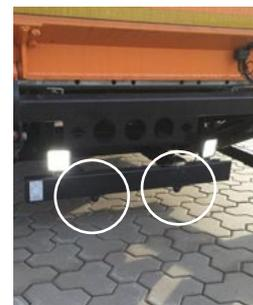
Ultraschallsysteme bestehen aus mehreren Sensoren und einer Steuereinheit (ECU = Electronic Control Unit), siehe Bild rechts. Die ECU verarbeitet die von den Sensoren empfangenen Abstandsdaten. Der Datenaustausch erfolgt über die CAN-Schnittstelle (CAN = Controller Area Network).
