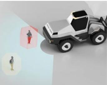
Grafik oben: Darstellung einer Personenerkennung im rückwärtigen Gefahrenbereich eines Radladers durch die am Heck angebrachte KI-Kamera.
