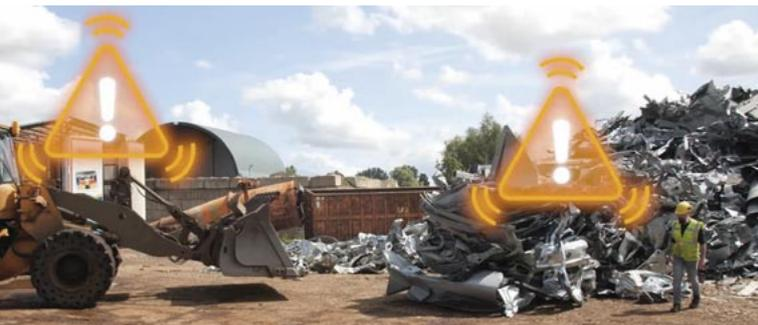
Ein sensorisches System warnt bei akuter Gefahr den Fahrer und schärft seine Aufmerksamkeit z.B. durch ein deutliches akustisches Warnsignal. Beim Blick auf den Monitor des Kamera-Monitor-Systems erhält der Fahrer Informationen darüber, wer oder was in seinem Arbeits- bzw. Gefahrenbereich aufgetaucht und gefährdet ist. Häufig ist eine Kamera bereits werksseitig auf der mobilen Maschine angebaut. Dann kann sinnvollerweise ein sensorisches System gegen nachlassende Aufmerksamkeit ergänzt werden.
