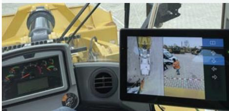
Foto links: Monitor eines Rundumsicht-KMS in der Fahrerkabine eines Radladers. Der Fahrer kann das Nahfeld rund um seine Maschine überblicken und gleichzeitig den rückwärtigen Bereich in der Großaufnahme beobachten.
