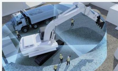
Eine Echtzeit-Abbildung der Umgebung rund um die Maschine kann auf unterschiedliche Arten erfolgen – Grundlage bildet jeweils der Einsatz von 4 Kameras (bzw. je nach Anforderung 3 Kameras für eine 270° Darstellung):
