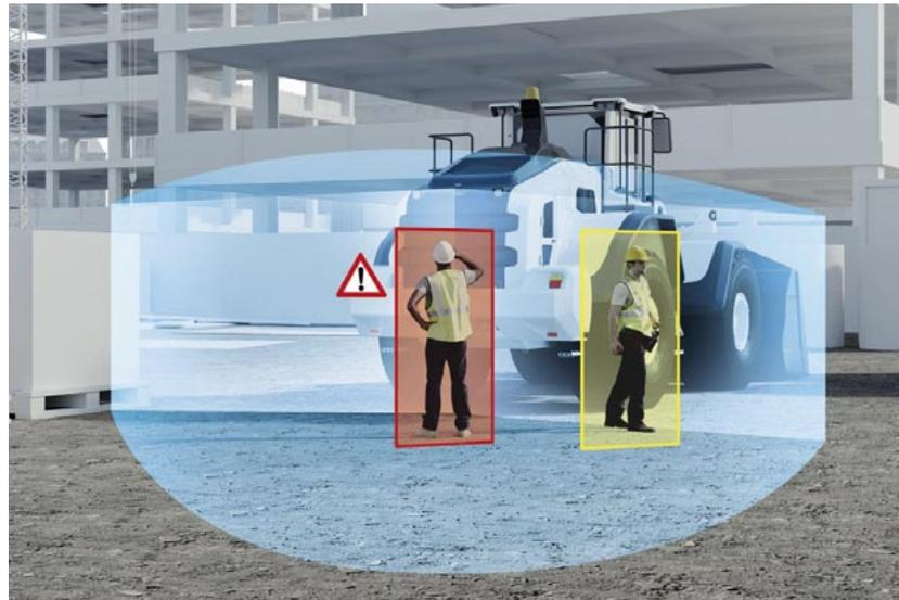
Abbildung oben – Anwendungsbeispiel Personenerkennung: Die am Radlader montierten und damit bekannten Kamerapositionen werden herangezogen, um eine ausreichend genaue Entfernungseinschätzung abzugeben, die eine rechtzeitige Warnung möglich macht. Voraussetzung dafür ist ein einmaliger Kalibriervorgang bei Montage der Kameras.
