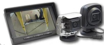
Komponentenbeispiele oben: Monitor mit Darstellung einer Rundumsicht aus vier Einzelansichten, daneben zwei Kameramodelle mit und ohne Heavy-Duty-Gehäuse.
