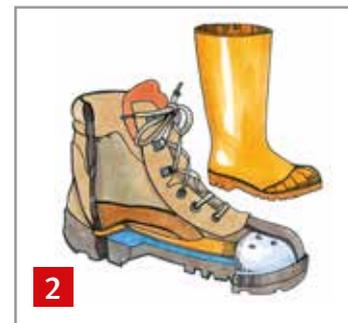
Auf dem Bau sind z. B. S3-Schutzschuhe oder S5-Sicherheitsgummistiefel erforderlich.
