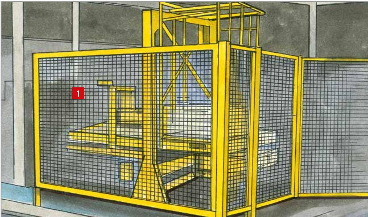
Lassen sich Gefahrstellen an Maschine und Anlage nicht durch konstruktive Maßnahmen vermeiden, müssen diese durch Schutzeinrichtungen gesichert werden.
