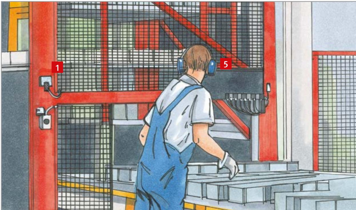
Mit der Hubleiter werden die auf Unterlagen produzierten Betonwaren dem Trocknungsbereich übergeben und mit der Senkleiter wieder der Weiterbearbeitung zugeführt.
