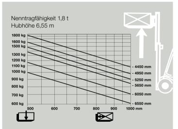
Beispiel für ein Tragfähigkeitsschild. Es zeigt die Abhängigkeit der Tragfähigkeit von der Hubhöhe der Last und dem Lastschwerpunkt.
