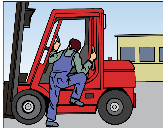
Verlassen Sie den Gabelstapler rückwärts mit Blickrichtung zum Fahrersitz. Benutzen Sie vorhandene Haltegriffe und Aufstiege. Nicht abspringen.
