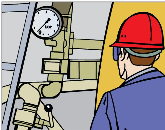
Vor dem Lösen der Kupplung ist zu prüfen, ob die Förderleitung drucklos ist.
