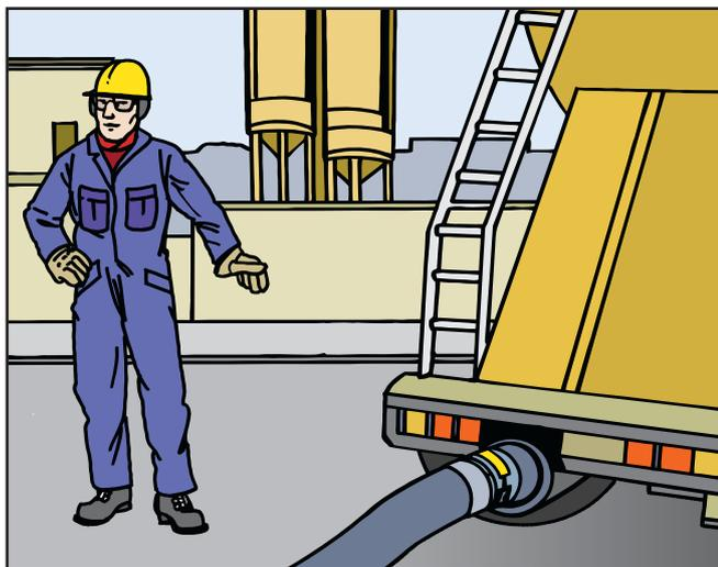
Beim Befüllen Overall, Helm, Schutzschuhe, Handschuhe sowie eine Schutzbrille tragen, die die Augen vollständig umschließt. Sicherheitsabstand zur Kupplung einhalten.
