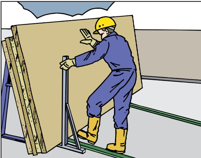
Nutzen Sie alternativ Hilfsmittel wie z. B. die Sieko-Stütze, um ein Kippen der Platten im A-Bock-Lager zu verhindern.
