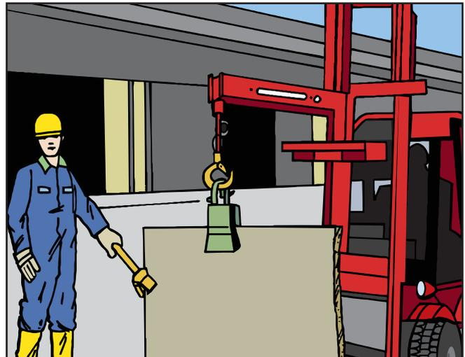
Verwenden Sie beim Transport von Rohplatten mit dem Gabelstapler Hilfsmittel, um die Platte zu führen. Gefahrenbereich nicht betreten.
