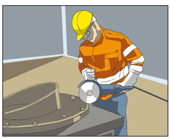
Winkelschleifer sind an den vorhandenen Griffen beidhändig zu führen. Das Verkanten ist zu verhindern.
