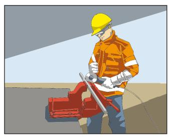
Zu bearbeitende Werkstücke müssen sicher eingespannt sein.
