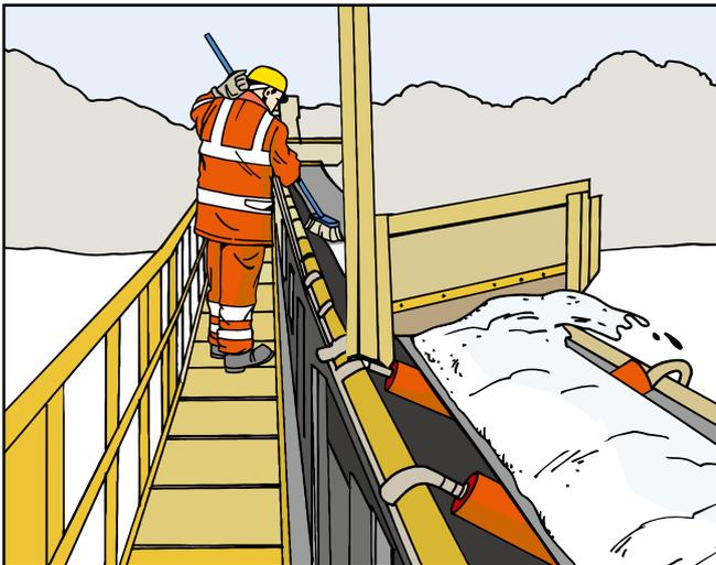
Beseitigen Sie vor Produktionsbeginn Eisschollen und Schneelasten durch Abfegen oder fest installierte Pflugabstreifer.
