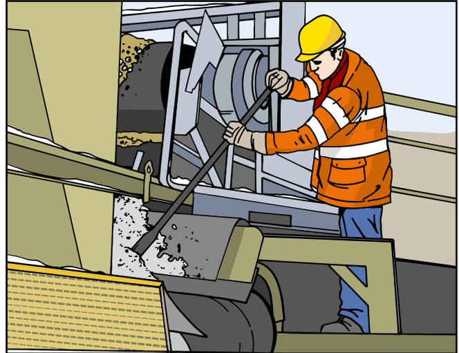
Entfernen Sie regelmäßig bei abgeschaltetem Förderband Schnee und Eis an den Übergabestellen. Die Schutzeinrichtungen müssen danach montiert und funktionsfähig sein.
